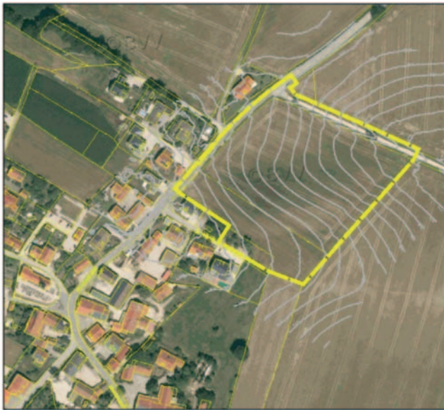
Luftbild der Bayerischen Vermessungsverwaltung, Ausschnitt Attenhausen mit Eintragung des Geltungsbereichs (gelb gestrichelt) und Darstellung der Höhenschichtlinien (Abstand 1,0 m)
